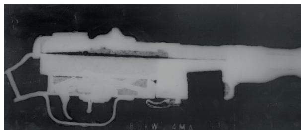
Obr. 95. Smolkov. Samopalu sovětské výroby Špagin. Dole rentgenový snímek. Hodnoty expozice: ffp. 70 cm, 80kV, 4mA, 130 s. (autorky: Mgr. Zuzana Plachká (SZM), Ing. et Mgr. Hana Rajhelová (SU), upravil Jiří Juchelka).
